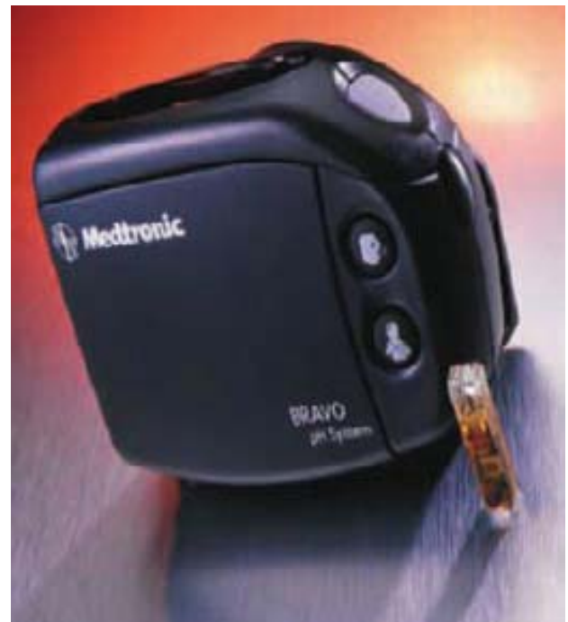
תמונה 1.ג. המקלט החיצוני הנישא על ידי הנבדק אשר קולט ורושם את האותות המשודרים מן הקפסולה
